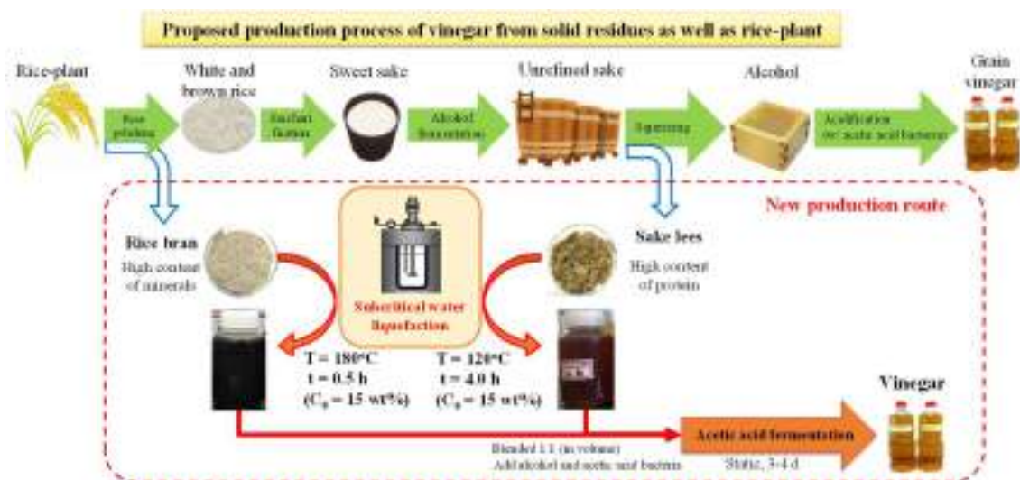
図. 提案する米ヌカ・酒カスも原料とする酢生産プロセススキームと実施例.
